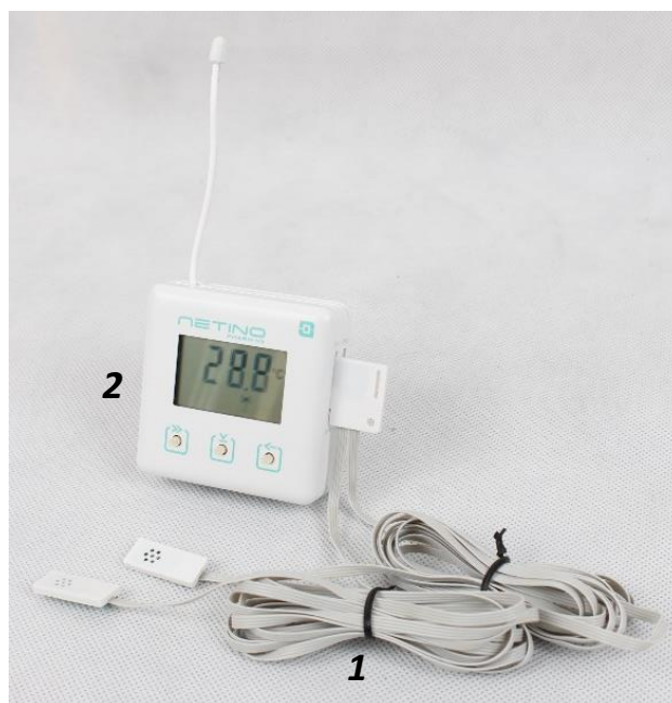
Rys. 2. Czujnik NXT-03-2K2,5(1) + baza NXBD*(2)
