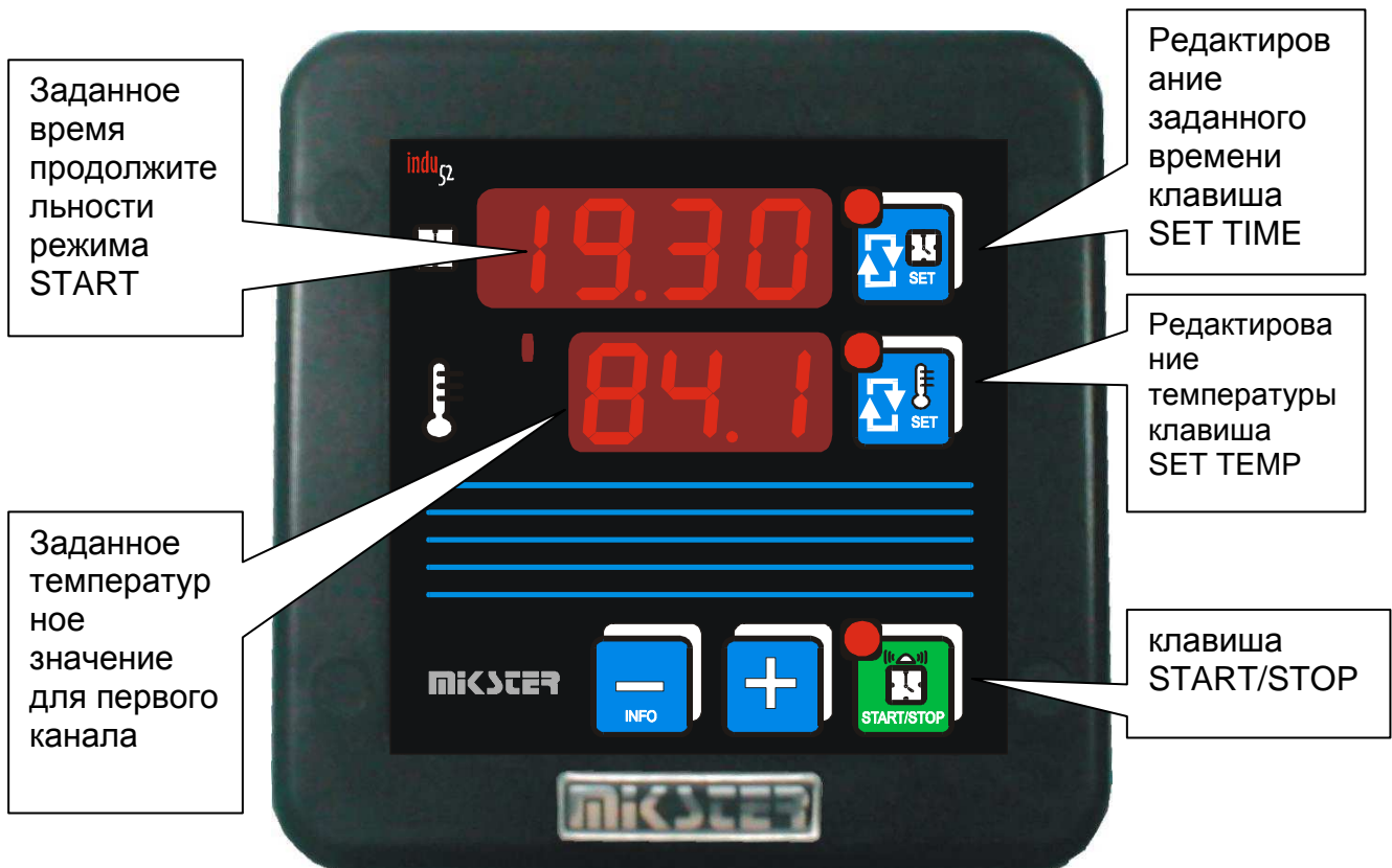
Рис: 1 Передняя плата контроллера INDU-52
