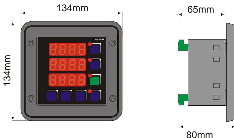
Монтажное отверстие 90x90мм.
