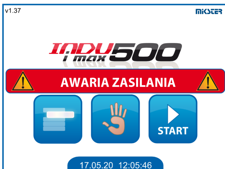
Ekran po wystąpieniu awarii zasilania, przerywającej program.
